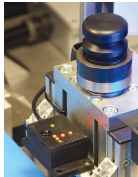
Figura 2 – HCE-TMP-01, sensore di temperatura ad alta velocità montato su un impianto
